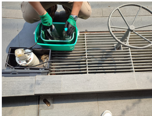
การเก็บตัวอย่างน้ำทิ้งที่บ่อตรวจคุณภาพน้ำทิ้ง ด้วยวิธี Sampling Pump
